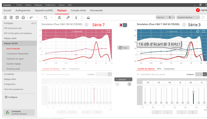
Figure 6 : Comparatif de sélectivité fréquentielle des courbes de réponse des séries 3 et 7
