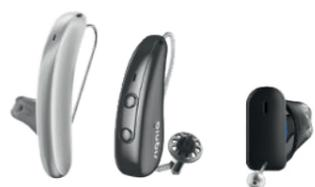
Für Menschen mit nicht versorgbarem Hörverlust auf einem Ohr. Das CROS-System empfängt den Schall auf der nicht versorgbaren Seite und überträgt diesen in das Hörgerät auf der anderen Seite. Damit wird die Ansprechbarkeit von beiden Seiten gewährleistet.
