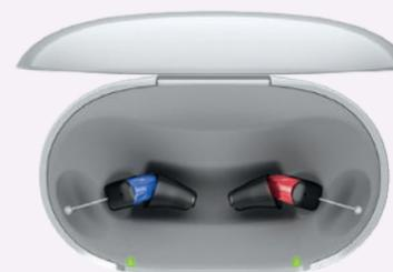
Gerade bei derart kleinen Geräten ist es eine große Herausforderung, die Handhabung einfach zu gestalten. Mit dem aufladbaren Silk Charge&Go IX ist dies vorbildlich gelungen. Denn der eingebaute Lithium-Ionen-Akku und der Mobile Silk Charger lassen den Batteriewechsel entfallen. Das Beste: Die Hörgeräte schalten beim Herausnehmen aus dem mobilen Ladeetui automatisch ein und beim erneuten Einsetzen wieder aus.
